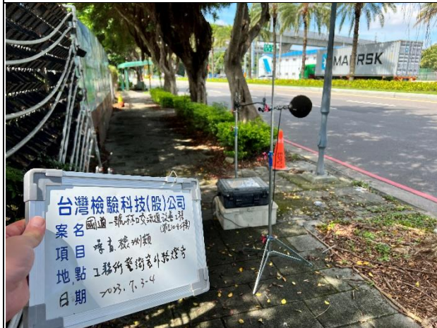
監測項目：環境噪音振動 監測日期：2023.07.03~04 監測地點：工務所警衛室外路燈旁
